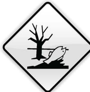
Если в транспортном пакете, содержатся опасные для окружающей среды вещества, и соответствующие маркировочные знаки не видны снаружи транспортного пакета, то на транспортный пакет дополнительно должен наноситься маркировочный знак вещества, опасного для окружающей среды.
