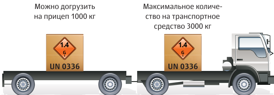
Рис. 4.3. Пример максимальной загрузки транспортной единицы опасным грузом № ООН 0336, при которой не требуется Свидетельство о допущении транспортных средств к перевозке некоторых опасных грузов. При определении максимальных количеств используются понятия «Транспортное средство» и «Транспортная единица»
