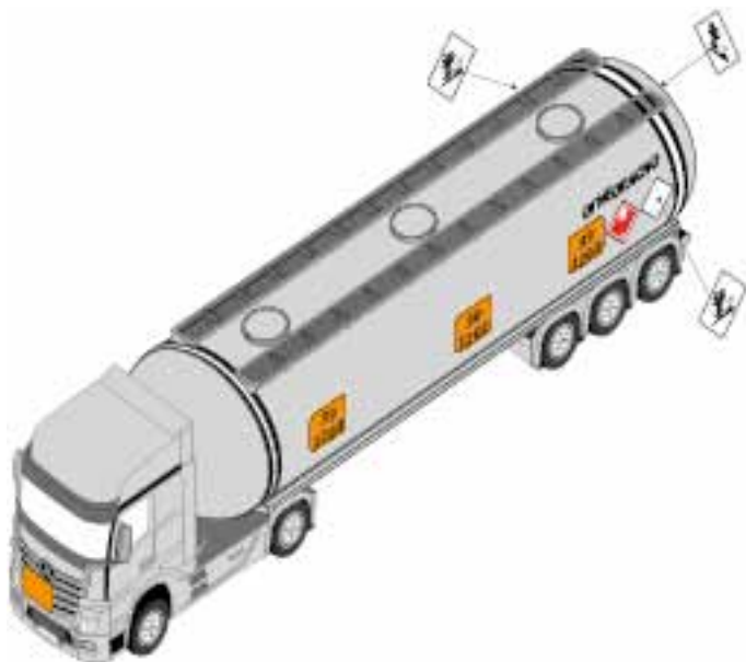
Рис. 5.9. Места крепления на автоцистерне маркировочных знаков для веществ, опасных для окружающей среды
